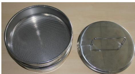
Fig. 1 : Exemple de tamis utilisé pour la recherche d'*Orobanche* spp. dans des échantillons de chanvre.
