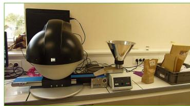
VideometerLab® et bande convoyeuse
